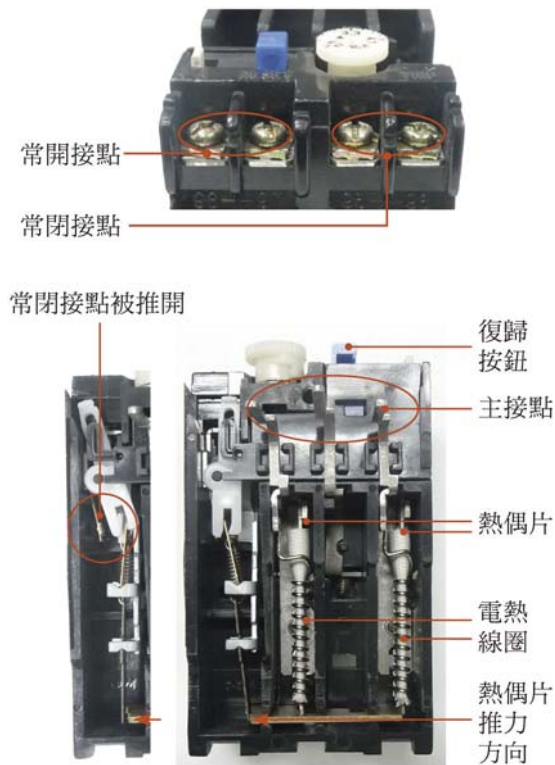
圖四 電磁開關及其控制電路
